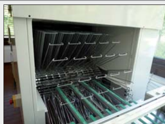
Übergabeband mit Einlaufmodul
