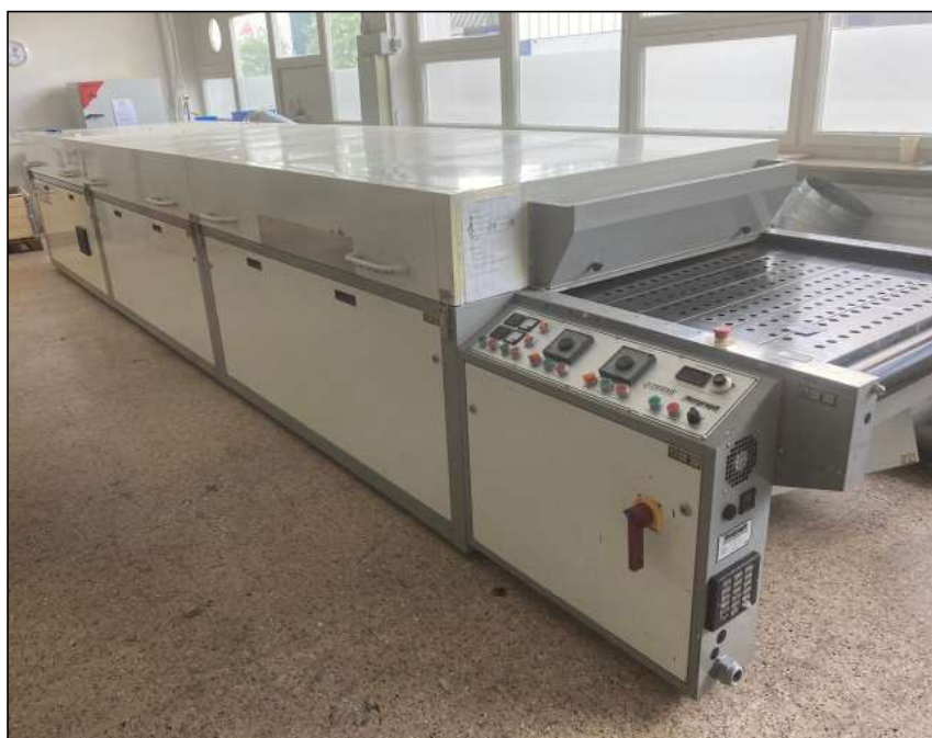
Natgraph Typ 90-4220TJ Siebdrucktrockner
