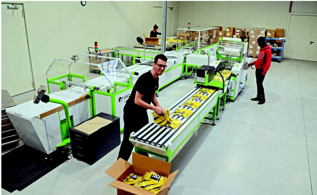
Da kann der BVB „eingepackt“ werden: Mit seiner neuen Falt- und Verpackungsstraße werden bei Logotex innerhalb von vier Minuten 45 Trikots des Fußball-Bundesligisten verpackt und gestapelt. (Fotos: Stefan Roller-Aßfalg)
