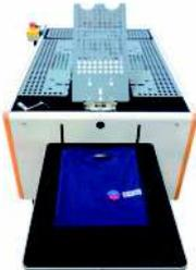
Stapeleinrichtung mit optischem Sensor zum Ablegen der Textilien
