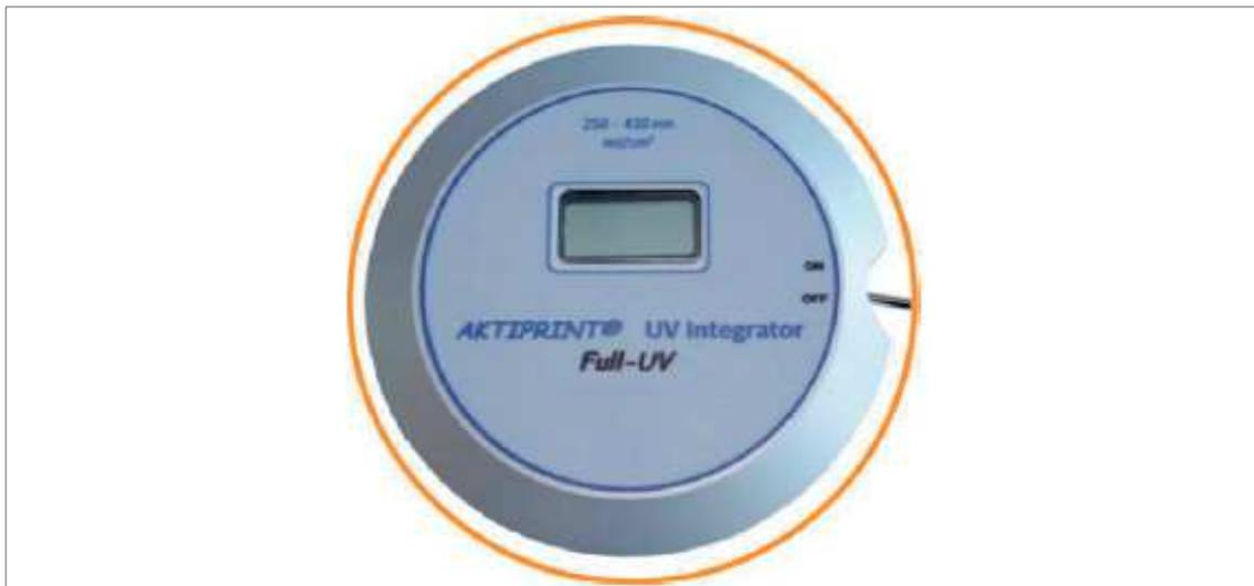
Der 12 mm flache UV-Integrator Full-UV dient als Durchlaufmessgerät zur regelmäßigen Leistungskontrolle der momentanen Bestrahlungsenergie  $E$  von UV-Trocknern und zum Ermitteln der erforderlichen UV-Strahlungsmenge für eine vollständige Aushärtung der UV-Beschichtung und ist somit zum Feststellen der benötigten Transportbandgeschwindigkeit bestimmt. Der UV-Integrator Full-UV deckt den Bereich der UV-C, UV-B und UV-A Strahlung zwischen 250 und 410 nm ab.
