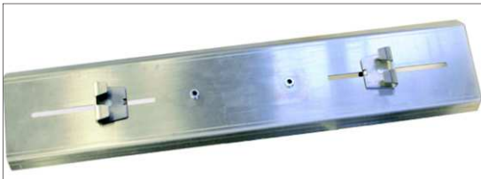
Abb. Aufnahme-Deckel mit Halter für M + R Rakel
