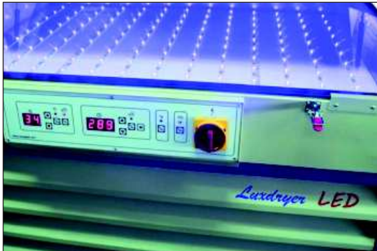
Spezielle UV - LED's für schnelle und präzise Schablonenbelichtung
