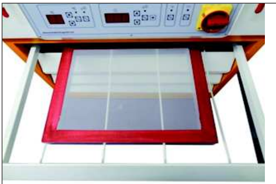
Aufnahmestange zur Lagerung der Siebdruckschablone
